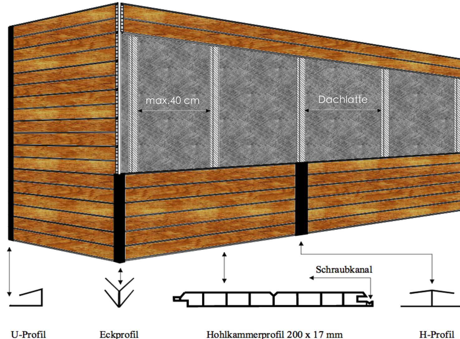
Für die Unterkonstruktion verwendet man Holzlatten mind. 28x48 mm, damit eine ausreichende Hinterlüftung gewährleistet ist.
